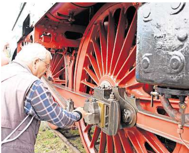
Der Antrieb der 18201 mit ihren gigantischen 2,30 Meter großen Treibrädern verzückt jeden Fan. Mit 180 km/h Spitzengeschwindigkeit ist die grüne Lok eine der schnellsten betriebsfähigen Dampflokomotiven der Welt.
